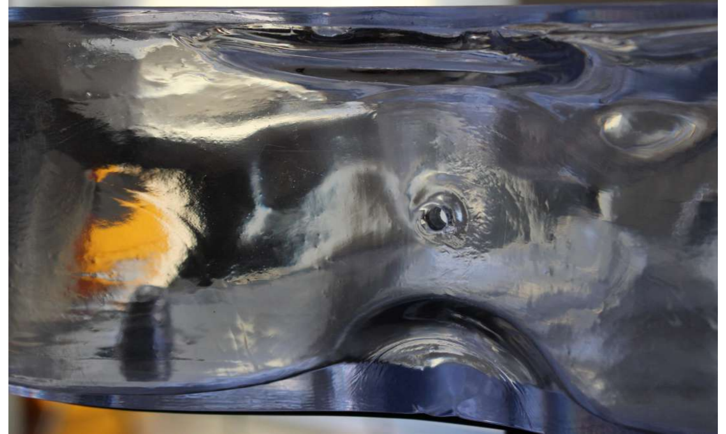
Alcuni pezzi possono presentare un foro che utilizziamo nel processo di soffiaggio e verniciatura. Certain products might present a hole that we use in the process of blow moulding and painting.
